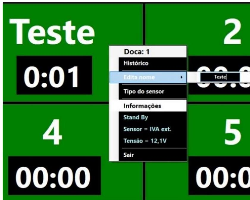
**Tipo do sensor** – Permite a escolha do tipo de sensor utilizado. As opções disponíveis são: ativo, refletivo, refletivo externo e IVA externo.
