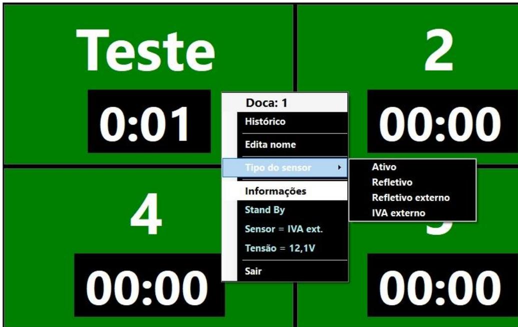
As opções “ativo” e “IVA externo” trabalham com sensores com contato NF, já as opções “refletivo” e “refletivo externo” trabalham com sensores com contato NA.
