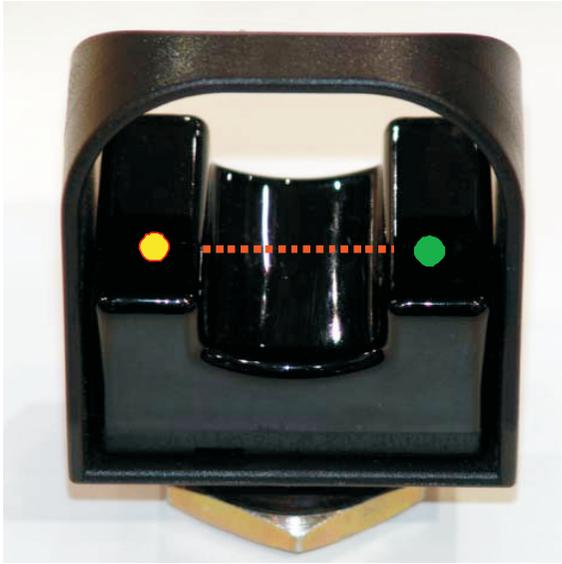
Os **Botões Ópticos** da **Decibel**<sup>®</sup> são dispositivos para acionamento de máquinas, através de sensores ópticos eletrônicos ativados por toque de dedo sem pressão mecânica. O acionamento (sinal de entrada) é feito pela interrupção de um feixe de luz infravermelho (dispositivo de atuação de comando).
